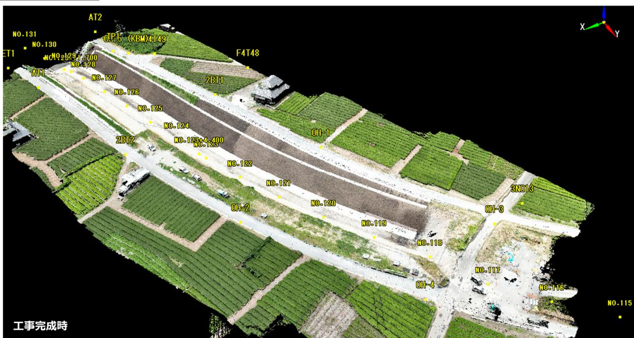
今回、ICT施工は道路土工にのみ適用されていた。国土交通省のガイドラインでは法面工も対象工事種として設定されているが、本工事では適用されておらず、受注者側から協議もしていない。ただし、これだけの3次元情報を取得しているにも関わらず利活用しないのは単純に勿体ない。
