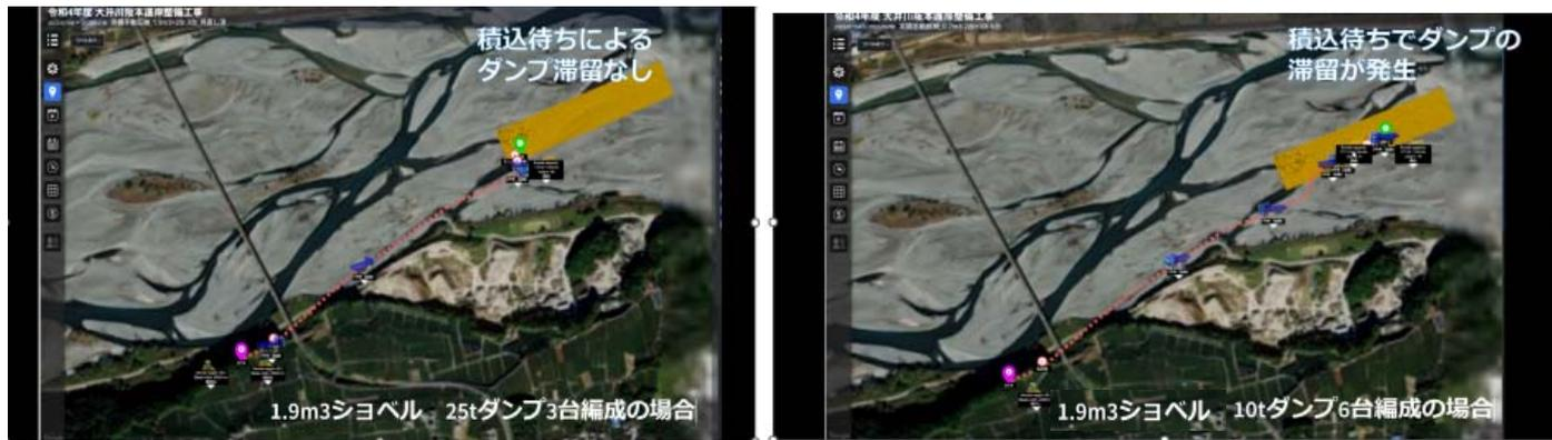
シュミレーションした結果、1.9m<sup>3</sup> BHと 10 t DT 6 台構成では、積み込み時に滞留が発生しダンプの待ち時間があり効率が悪い。よって、1.9m<sup>3</sup> BHと 25 t 積重ダンプの組み合わせが効率が良いと判明した。以前の運搬計画を立てる際は、自分の経験等を組み込み組み合わせの検討に時間を費やした覚えがあるが、今回、AI 機能を使うことで、使用機械の選定や運搬距離、数量から複数の組み合わせを最適な組み合わせとして求めることができた。
