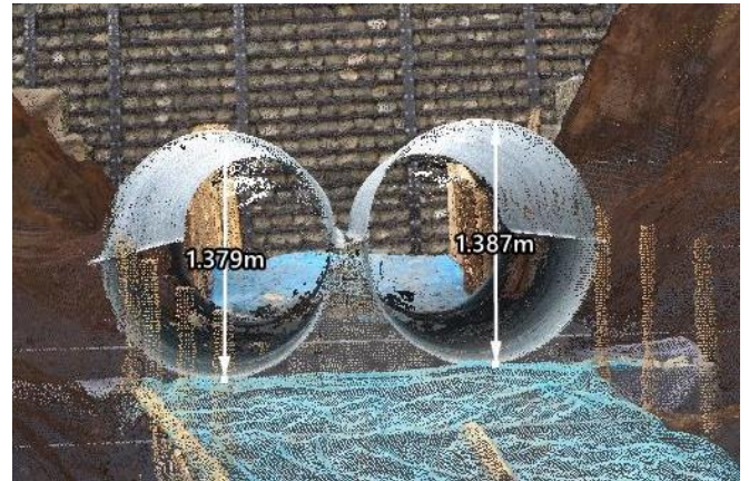
点群データによるコルゲートパイプ延長及び口径確認
