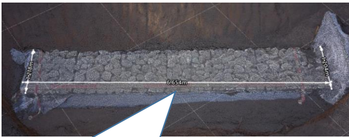
かご枠土留工 1 段目 点群計測データ
