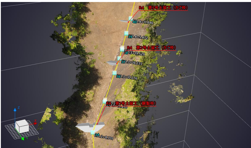
着工前点群データ+構造物 3D モデルデータ
