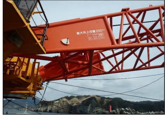
被覆ブロックの据付において設計上は、4t型ペルメックスは80t吊クレーン付台船を、8t型ホロスケーヤーについては150t吊非航起重機船を使用するようになっていますが、伊豆半島の西海岸側は冬季には強い西の季節風が吹き付ける地域であり、思うように工程が進まない地域でもあります。そこで、被覆ブロックの積込運搬据付作業には作業能力に十分余裕があり、尚且つ多少の波浪でも船体に安定性のある250t吊非航起重機船を使用しました。これにより、多少の西風も関係なく、安全に工事を進捗させ、工期内に工事を終わらせることが出来ました。
