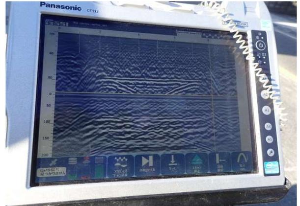
空洞探査機にて埋設物調査
