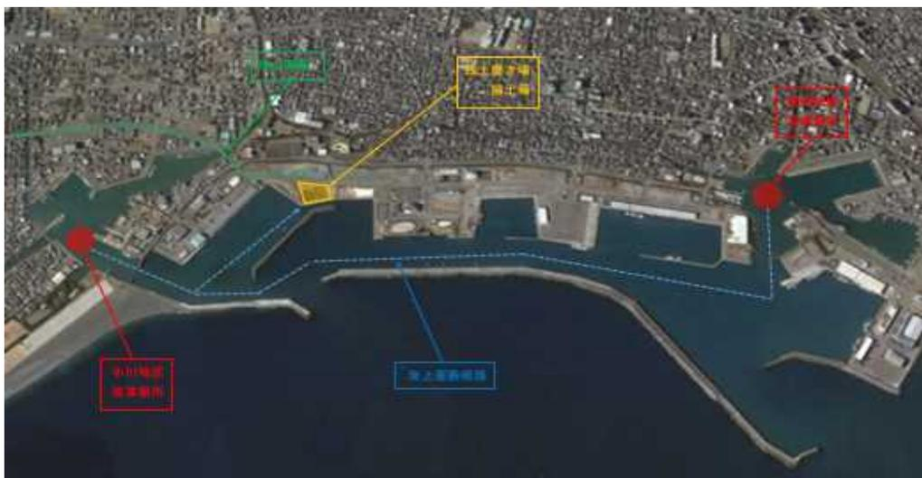
課題点 本工事の目的は漁港内の浚渫であるが、揚土場所に仮置きしてある土砂を処分しなければ浚渫土を揚土することが出来ないため先に揚土場所の残土を陸上処分をする必要がある。残土処分場所までの運搬距離は22kmと比較的長距離であるためダンプトラック運搬時の安全対策が重要であると考え、①過積載の防止対策及び②運搬時の安全対策についての対策を行った。
