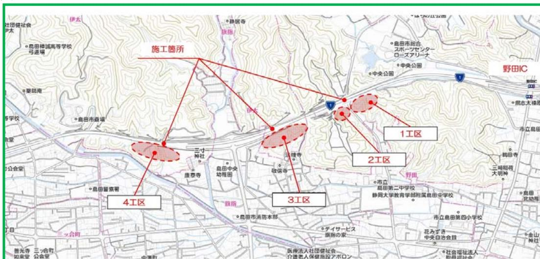
周辺状況 施工箇所は国道1号の4車線化工事の為、横が現国道となっている。施工延長が約1.3kmあり4ブロックに分かれている。通行車両は頻繁にあり、車両速度も速い。
