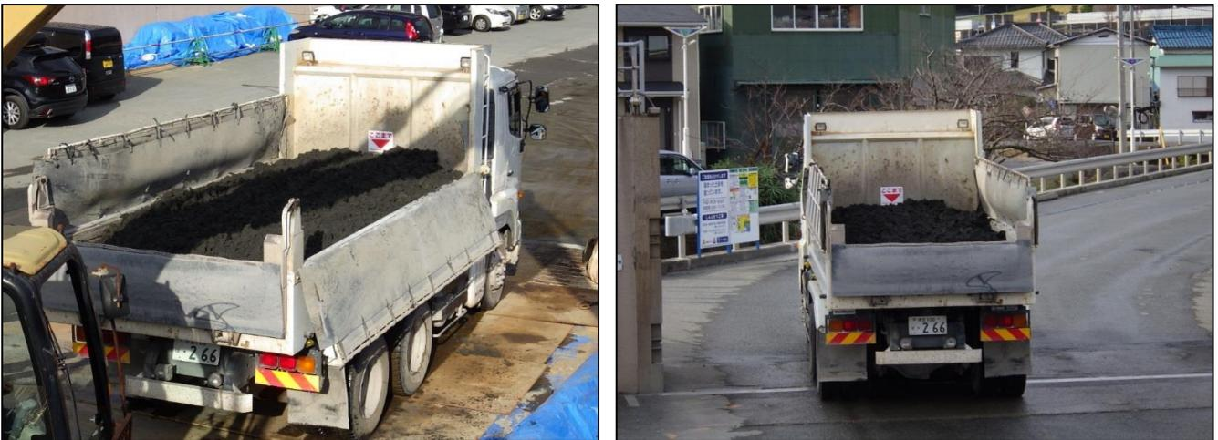
過積載防止として、バックホウのオペレーターから確実に見える場所へ「ここまで」と明示したマグネットを
