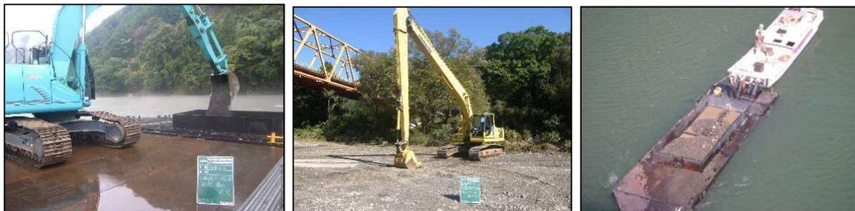
写真 2種類のバックホウの活用と土運船(底開タイプ)の利用
