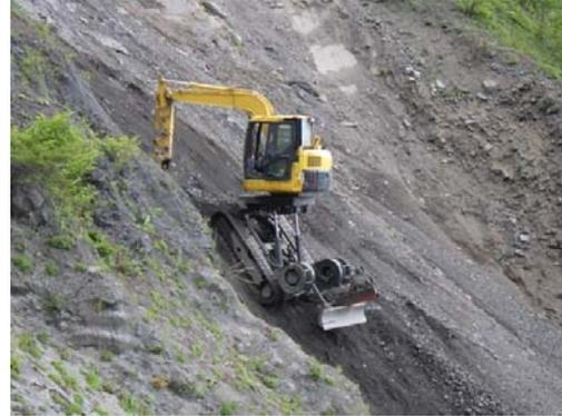
ロックライミングマシン (RCM-06) による法面整形状況
