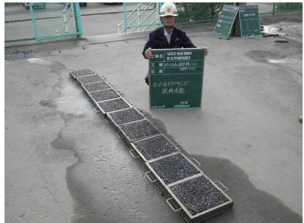
図-10 ホイールトラッキング試料採取
