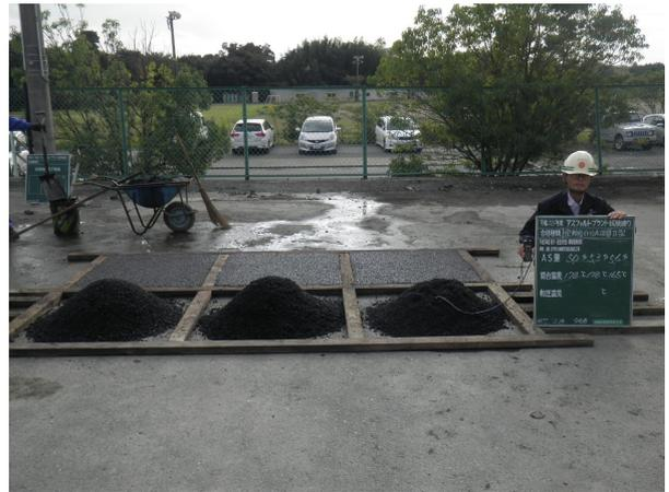
図-9 アスファルトプラント試験練り
