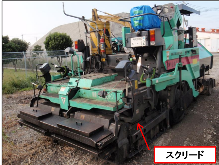
写真-1 アスファルトフィニッシャー
