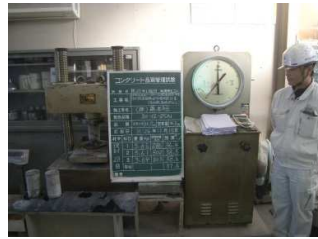
圧縮強度試験( \sigma 28 現場封かん) テストハンマーによる確認
