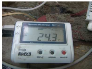
コンクリート温度
