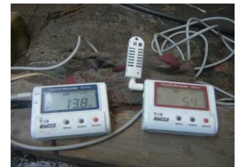
養生シート内温度、外気温
