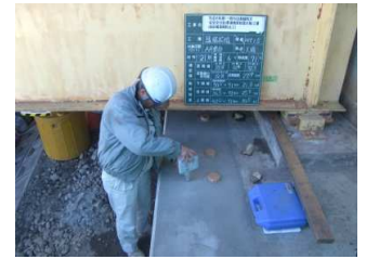
圧縮強度試験( \sigma 28 現場封かん) テストハンマーによる確認
