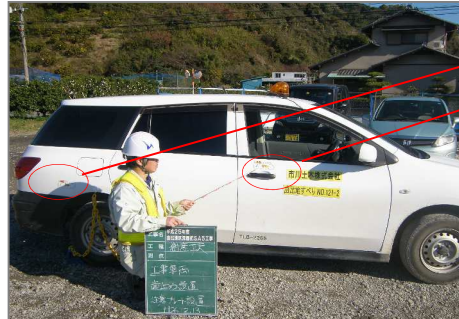
工事用車両に注意喚起のプレートを設置
