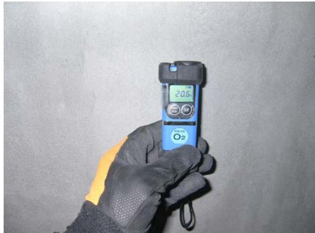
暗渠部：補修時 酸素濃度測定状況
