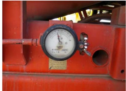
写真-6 過積載防止重量確認
