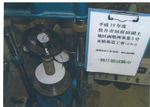
図-6 一軸圧縮試験中
