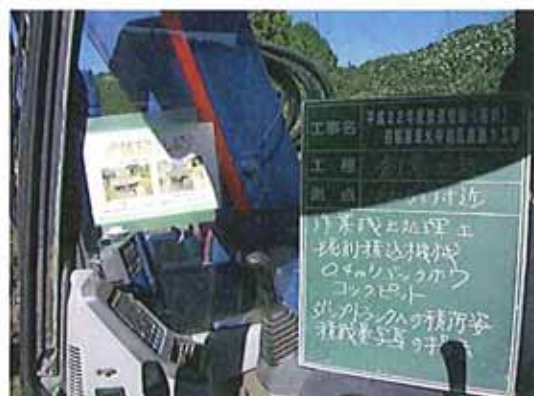
土砂積込機械コックピットへ ダンプ荷姿写真(手本)の掲示
