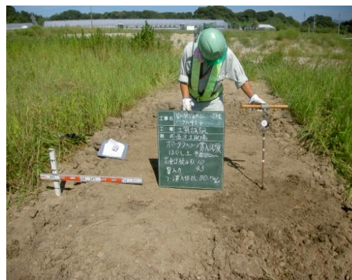
現場ポータブルコーン貫入試験
